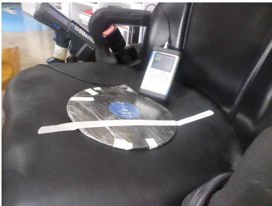
Figura 2 – Instalação do medidor de vibração na empilhadeira
